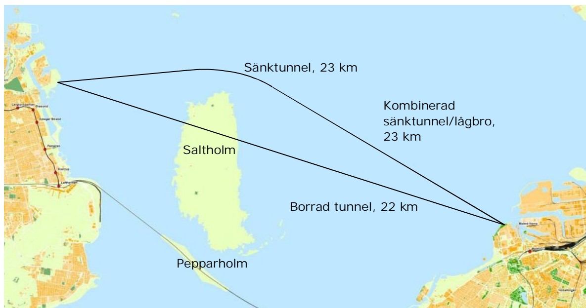
Figur 6: Undersökta linjeföringar för en borrade tunnel, en sänktunnel och en kombinerad sänktunnel – lågbro, kust till kust-förbindelse.
