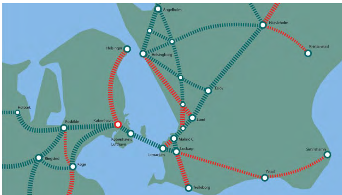
Figur 13. Illustration av kapacitetsbegränsningarna i scenario 2040. Röd färg indikerar att kapaciteten är fullt utnyttjad och möjligheten att köra fler tåg är kraftigt begränsad.
