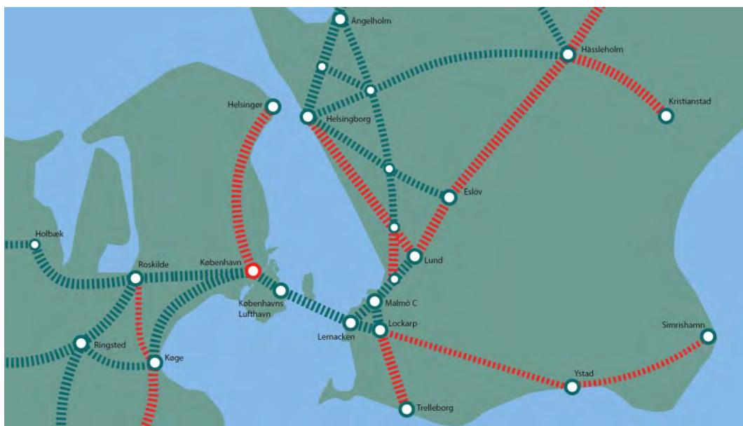
Figur 11. Illustration av kapacitetsbegränsningarna i scenario 2030. Röd färg indikerar att kapaciteten är fullt utnyttjad och möjligheten att köra fler tåg är kraftigt begränsad.
