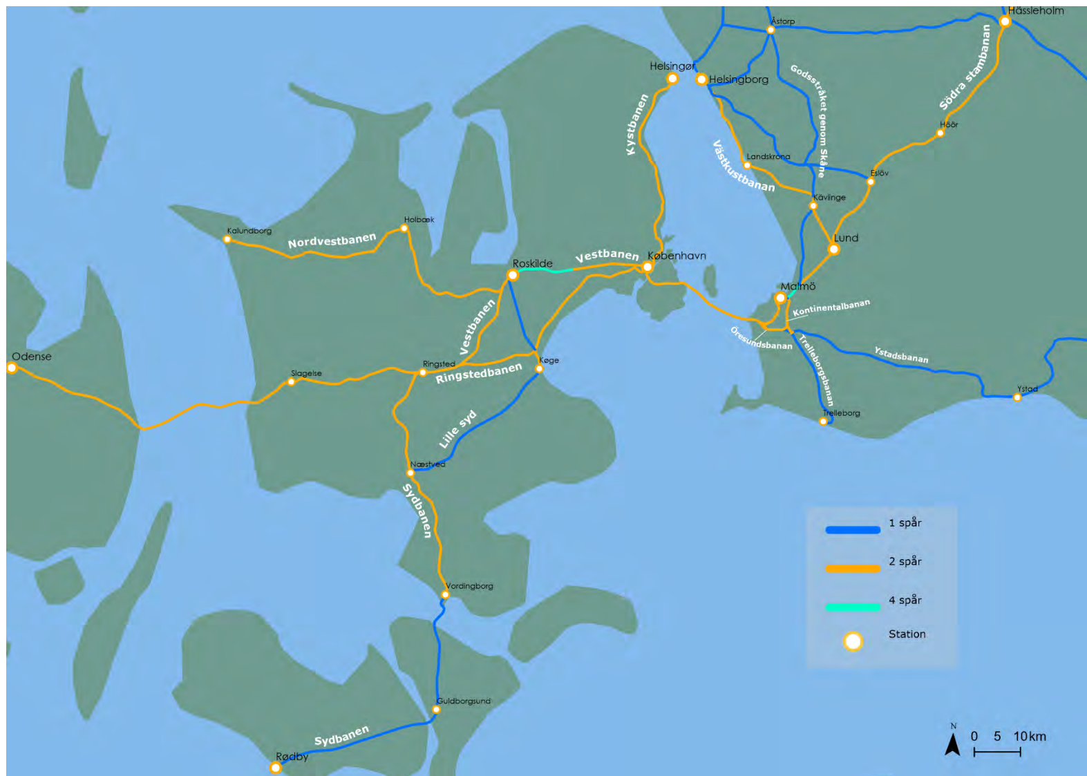
Figur 6 Karta som redovisar järnvägsinfrastrukturen i södra Sverige och östra Danmark. De olika färgerna indikerar om banan är utrustad med enkelspår (blått), dubbelspår (gult) eller fyrspår (grönt).
