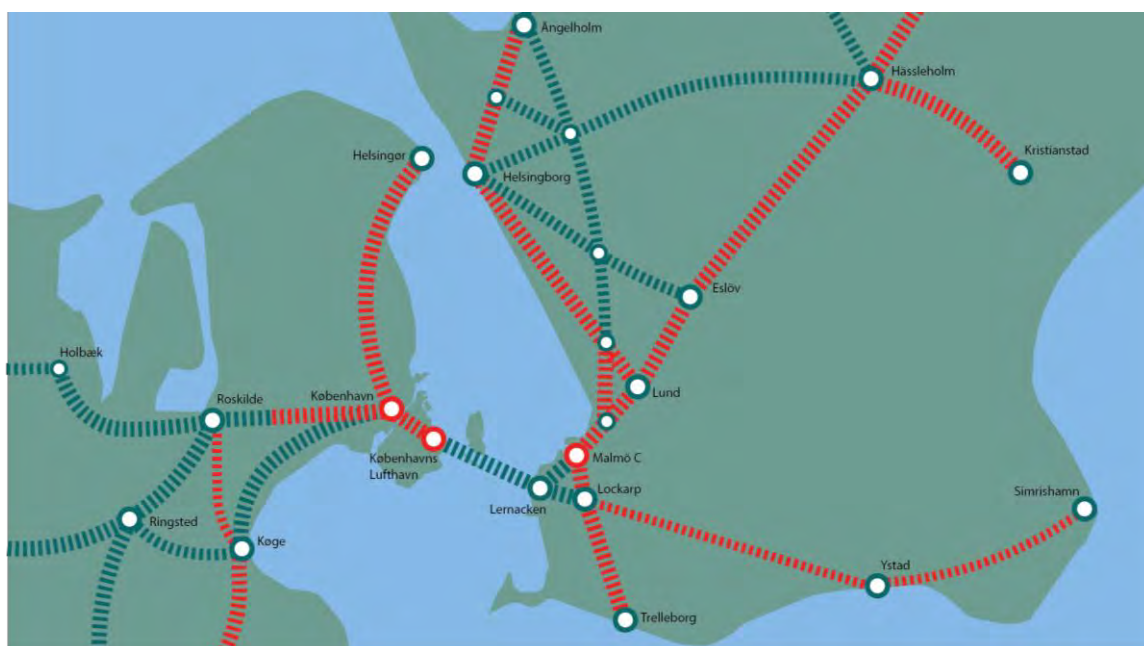
Figur 9. Illustration av kapacitetsbegränsningarna i dagens järnvägsnät. Röd färg indikerar att kapaciteten är fullt utnyttjad och möjligheten att köra fler tåg är kraftigt begränsad.
