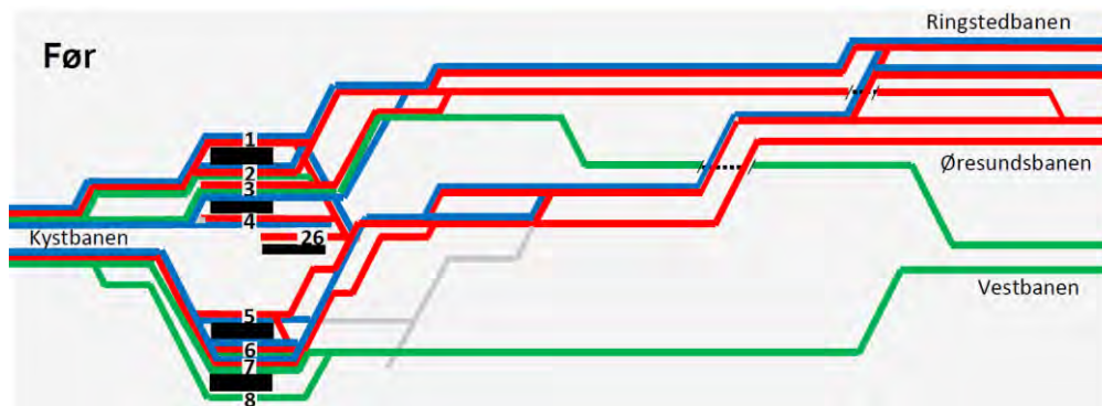
Figur 21. Schematisk översikt av Københavns Hovedbanegård. De tre anslutande banorna till höger i bild ligger i verkligheten sydväst om stationen (Banedanmark, 2021).
