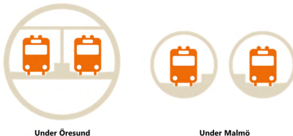
Figur 4. Tunnelkoncept för Öresundsmetron, tvärsnitt.
