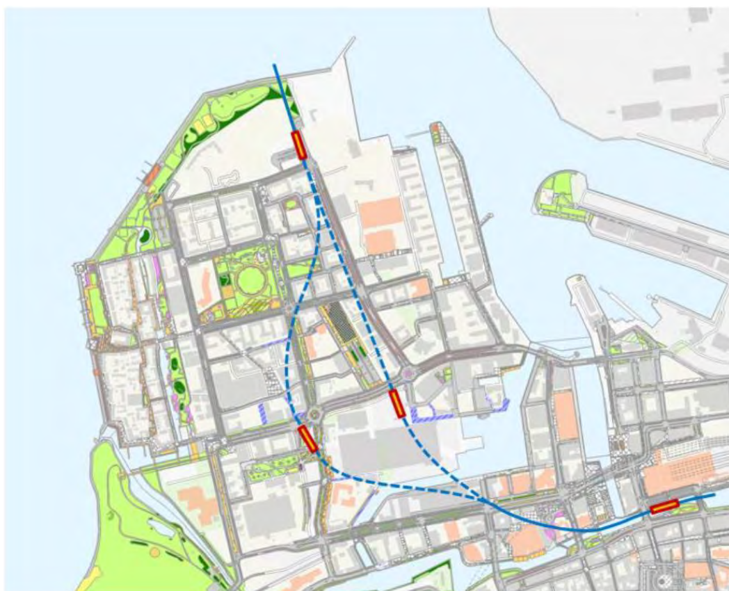
Figur 3. Preliminär linjeföring för Öresundsmetron samt placering av stationer i Malmö. Bilden visar två potentiella sträckningar (streckade linjer) genom Västra hamnen.
