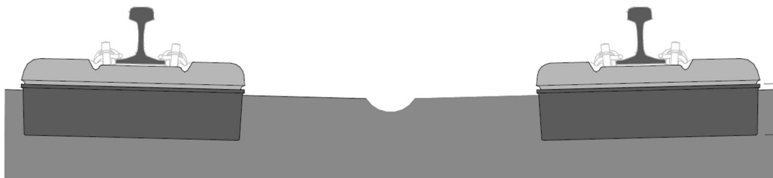
Figur 14. Snit i Sonnevilles LVT systemet hvor afløbsrenden er vist i midten. © Sonnevilles AG.
